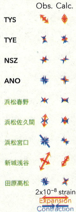
図31: 2016/1/7-9の歪・傾斜変化 (図27[E]) を説明する断層モデル。
