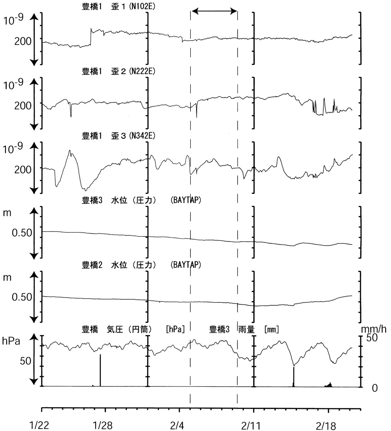
歪に関しては、BAYTAP-GIにより潮汐応答・気圧応答を除去し、さらに直線トレンドを除去している
