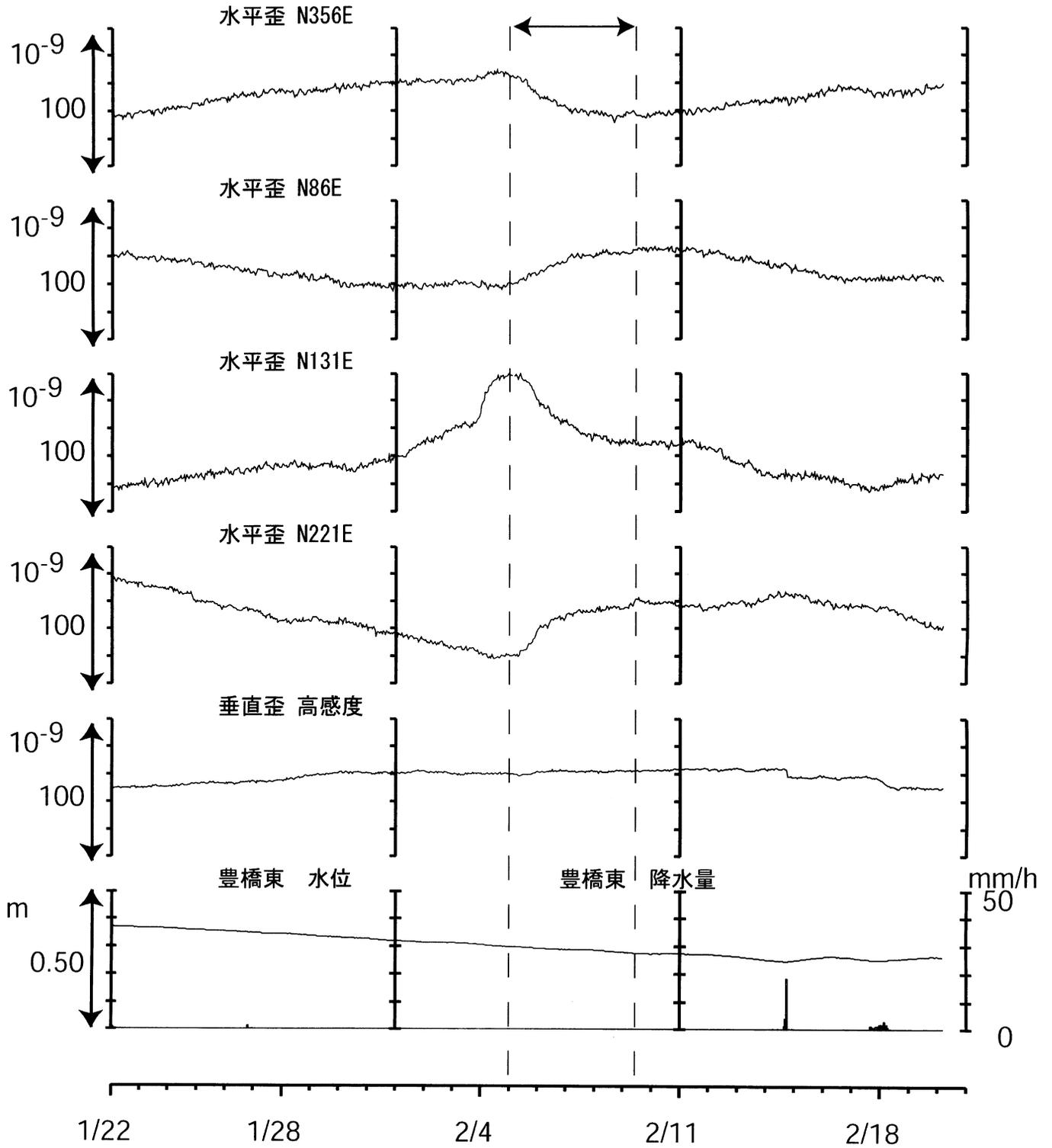
水平歪に関しては、BAYTAP-GIにより潮汐応答・気圧応答を除去し、さらに直線トレンドを除去している
