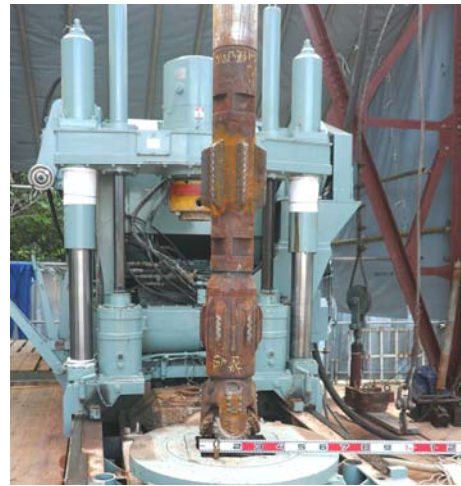
ボーリングマシンと掘削ビット
