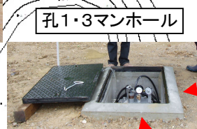
孔2(200m) 歪計 地震計 水位水温計
