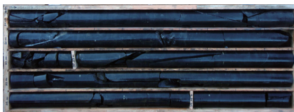
熊野層群敷屋累層の泥岩 孔 1 深度 30-35m ボーリングコア
