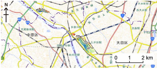
第 5.4 図 武蔵野 III 段丘堆積物基底の標高分布。 単位は T.P.+ m. 武蔵野 III 段丘堆積物は等高線を示した範囲に分布する。点印は基底面のモデリングに使用したボーリングデータ地点を示す。黄点は指定標高が基底面に相当するデータ地点、青点は指定標高よりも下に基底面が存在するデータ地点。背景図は地理院地図を使用。
