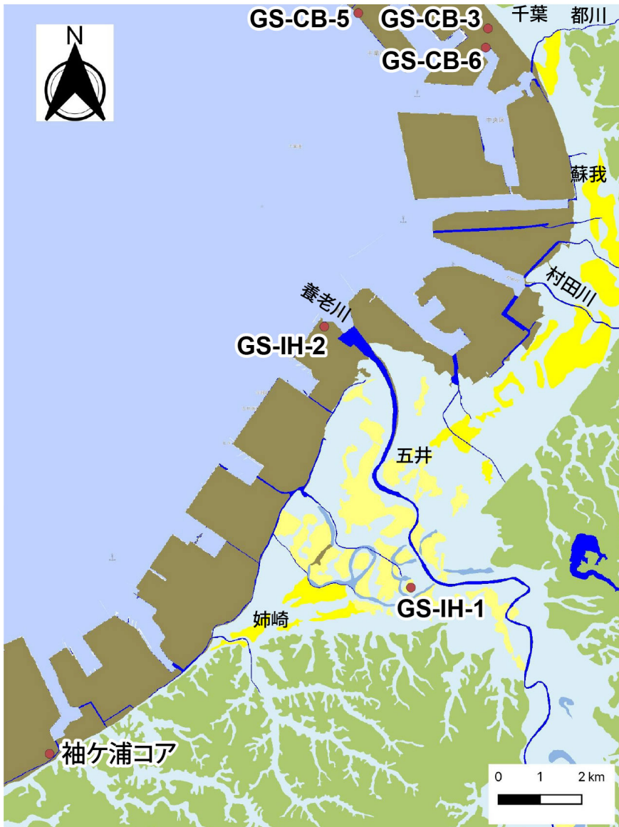
第2.2図 地質図（平面図）と基準ボーリング調査地点。 基準ボーリング調査の各諸元は第2.1表参照のこと。地質図の凡例はウェブサイト「都市域の地質地盤図」の地質図凡例を参照のこと。
