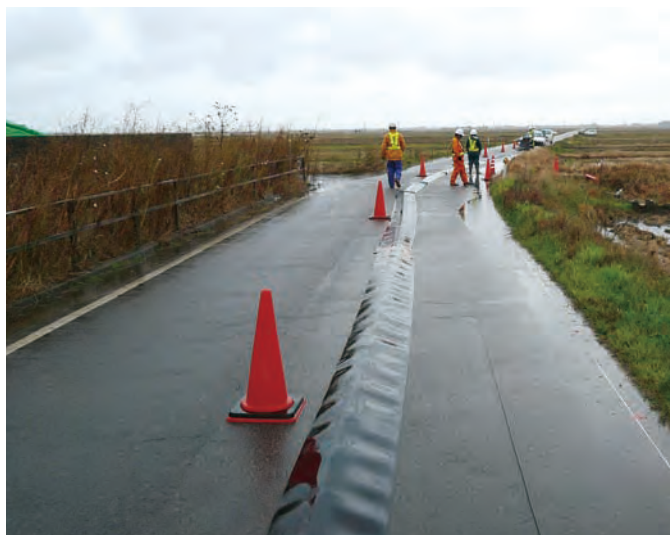
第 13 図 ランドストリーマー探査震源類. (a) ミニ油圧インパクト震源, (b) エアハンマー震源, (c) 全天候用ゴムマット.
