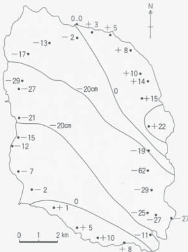
第6図 1986年12月の水準測量結果(国土地理院)。岡田を不動点とし、1982年10-11月に対する変動値。コンターは東京大学地震研究所の資料も考慮に入れて記入した。
