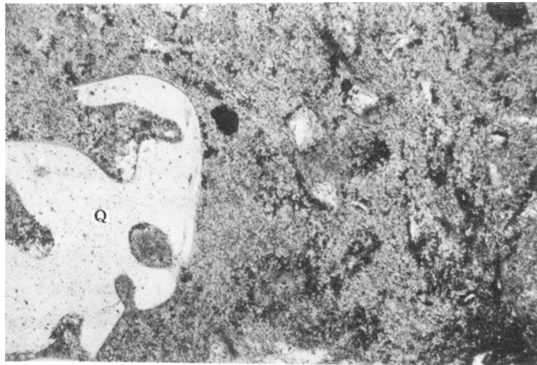
第26図 黒雲母デイサイト (KT72072806). 祖母山火山岩類, 第Ⅲ期火山岩類, デイサイト溶岩, 竹田市尾村南方1,800m, 越敷岳中腹標高840m. 微細な鉱物の珪長岩質組織をなす石基の中に, 融食形を示す大きな石英斑晶(Q)がみつめられる. 他の場所では斜長石, カリ長石がみつめられる. 開放ニコル.
