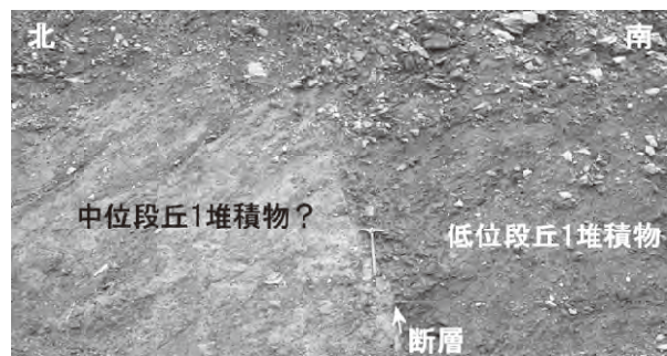
第 9. 3 図 石鎚断層の露頭 (四国中央市土居町小林, 第 8. 3 図 b の F3 地点) 中位段丘堆積物 (?) と低位段丘 1 堆積物が正断層で接する。ハンマーの柄の長さは約 40 cm。
