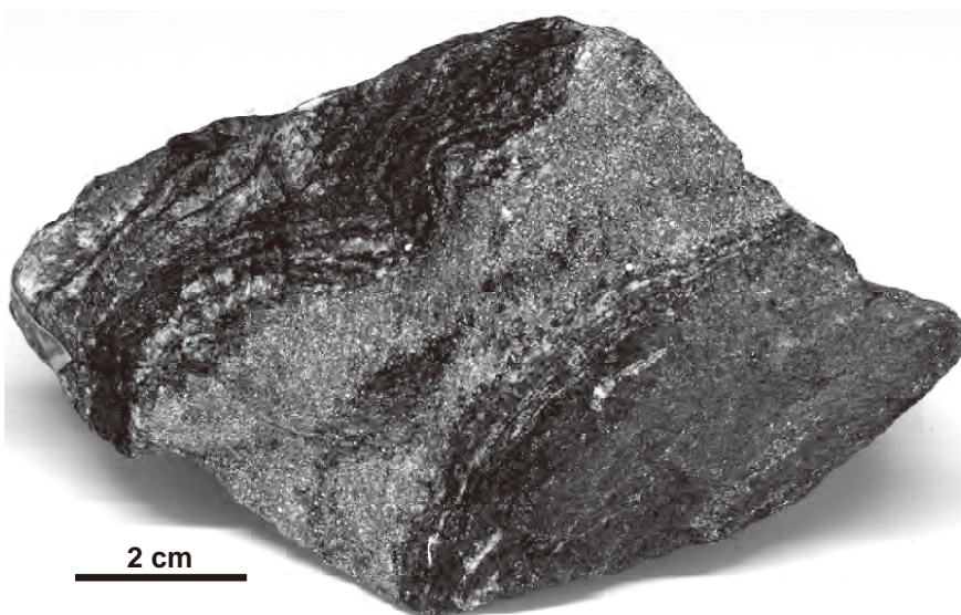
第10.9図 別子銅山産層状含銅硫化鉄鉱石 [GSJ M4337] の標本写真 写真右下が苦鉄質片岩，左上が珪質片岩で，中央部が鉱石部分。
