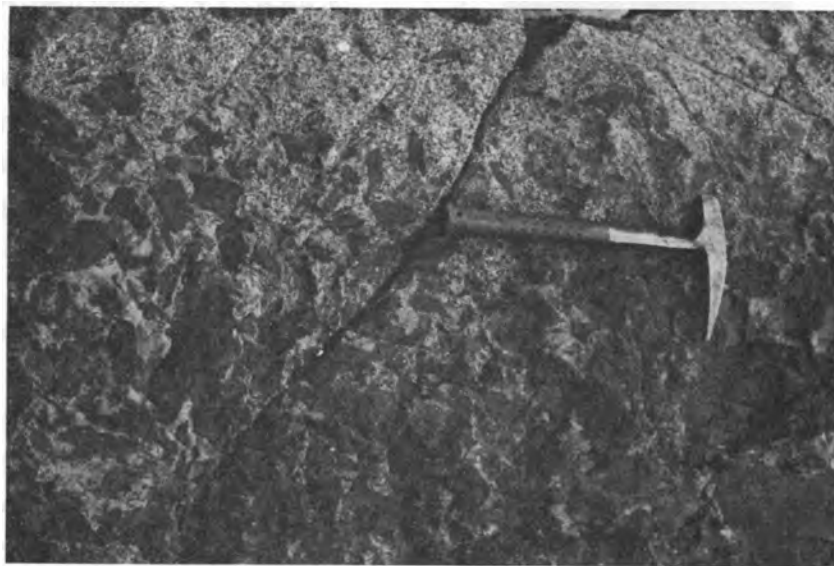
第23図 徳永砂岩部層(Tk)中の礫が泥岩角礫のみからなる礫岩 基質は粗粒砂岩 板取村三洞
