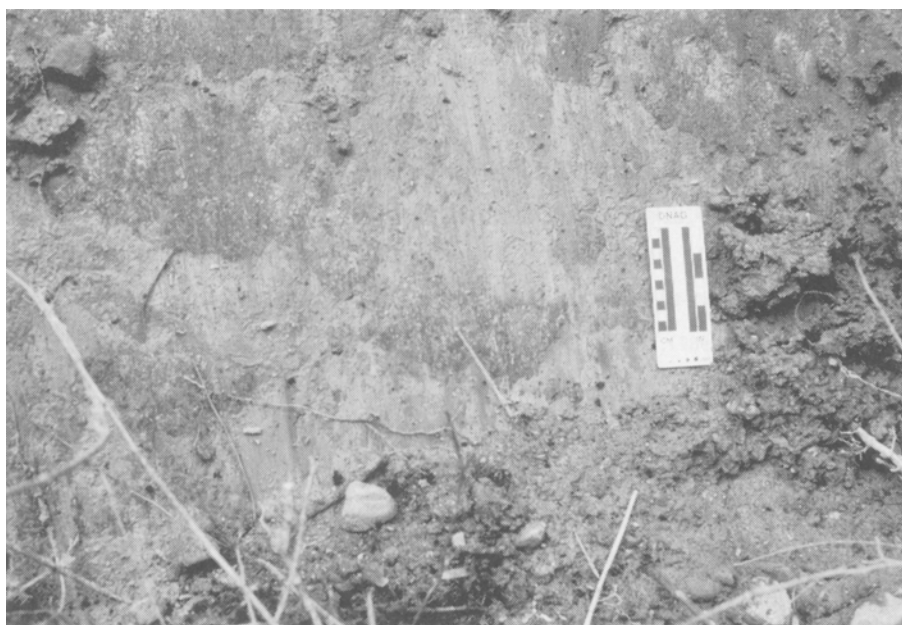
第45図 日影部層中の凝灰岩上面に地すべりによって生じたスリッケンサイド(小川村持京西方)
