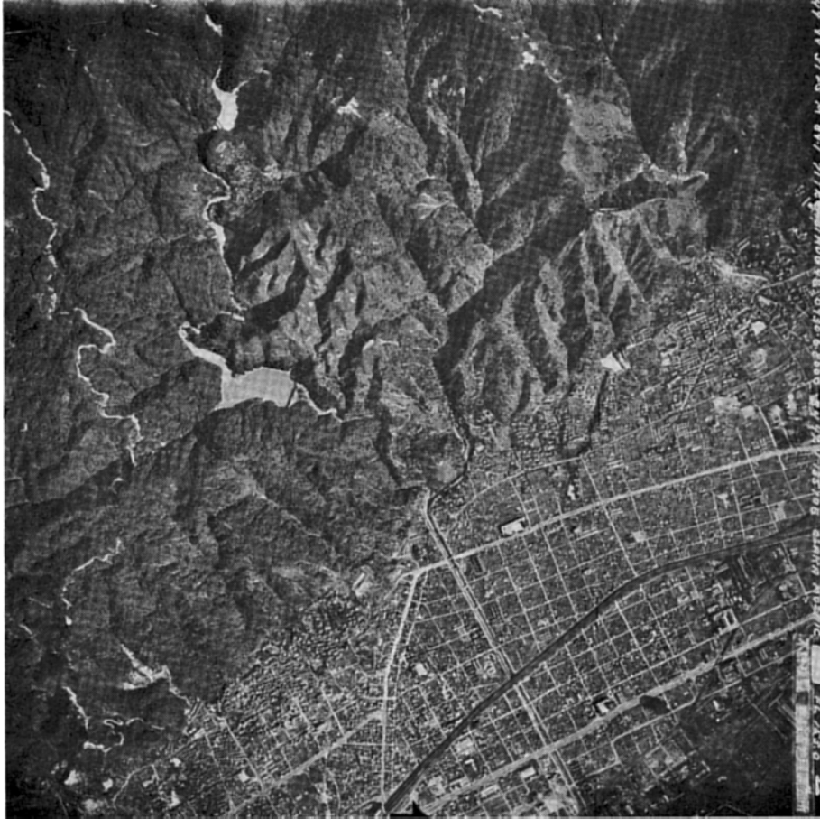
第33図 空中写真に見る諏訪山断層崖と右横ずれ変位を示す川の屈曲及び布引断層のリニアメント（国土地理院発行空中写真，昭和23年8月31日撮影を使用し，約7.5万分の1に縮小）地形図は原寸1万分の1のものを約3万分の1に縮小。
