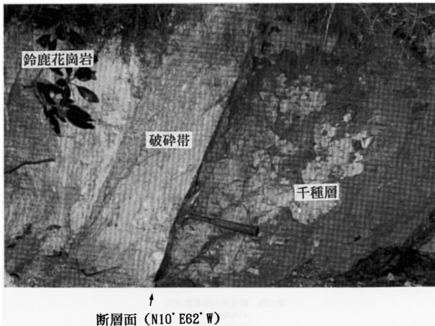
第74図 一志断層系の断層面の露頭写真(孤野町湯の山ゴルフ場西方)。ハンマーの長さは30cm
