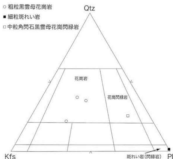
第4.1図 加茂地域の深成岩類のモードを示す三角図 Kfs: カリ長石, Pl: 斜長石, Qtz: 石英。
