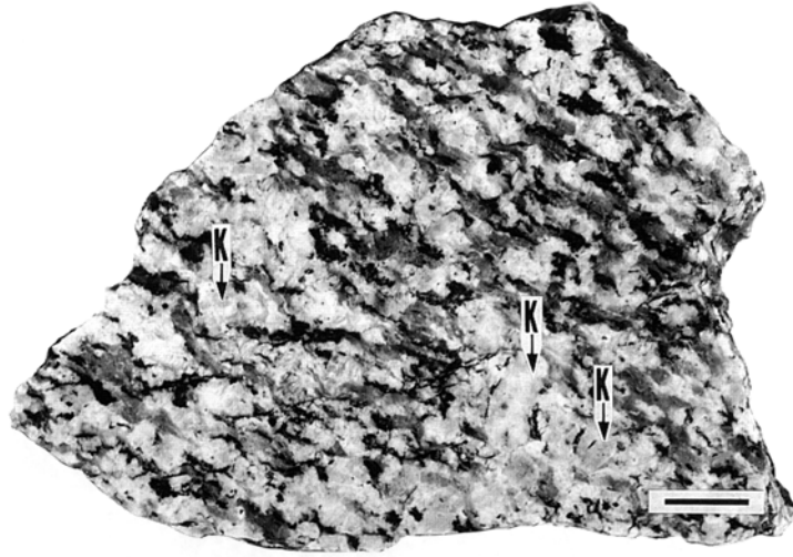
第 27 図 斑状カリ長石の目だつ中粒片状黒雲母花崗岩 K: カリ長石, スケールは 1cm
