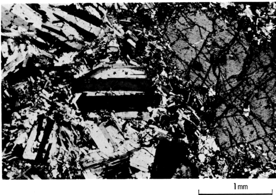
2. 斑れい岩の顕微鏡写真（梶内川支沢，直交ニコル）右端が単斜輝石，粗粒な輝石と斜長石の間の細粒部は黒雲母・角閃石・単斜輝石及び不透明鉱物などの集合物
