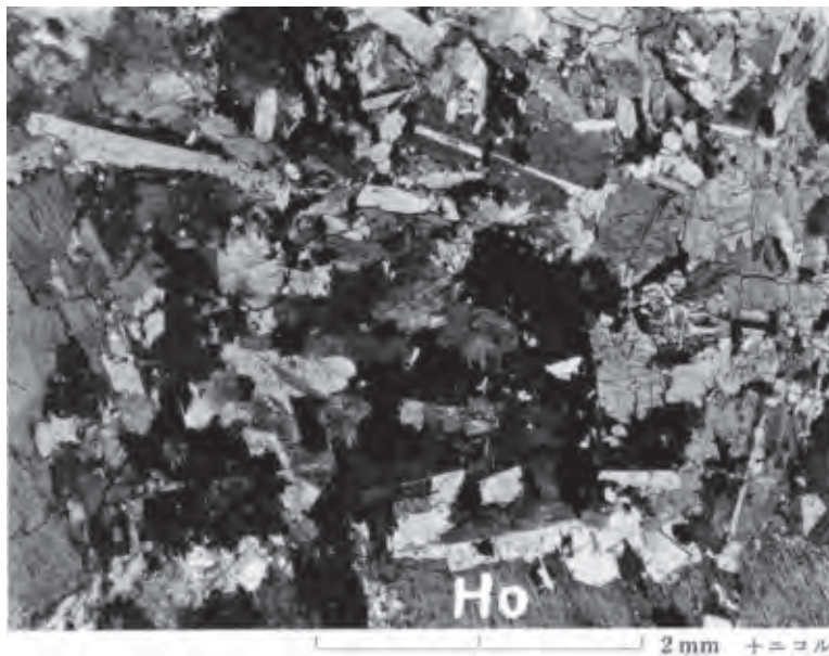
PL 17 ソシュール石はんれい岩中のかなり火成岩構造をとどめている岩相 (The rock facies holding igneous texture in saussurite gabbro)
